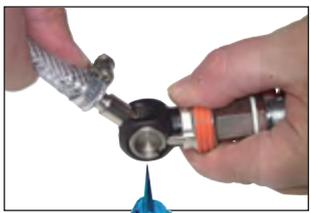
Kupplung ausschwenken - Kupplung schließt und entlüftet
